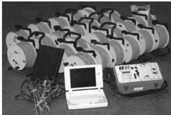
Fotografia 1 - Equipamento para execução de Tomografia Geoelectrica de Superfície. O resistivímetro Geopulse é controlado pelo computador através da porta série RS-232, e possui uma bateria interna que lhe permite trabalhar autonomamente no campo. É um instrumento de grande precisão capaz de obter valores de resistividade entre 0,001 W e 400 KW, debitando corrente eléctrica na gama 0,5-100 mA.
