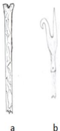
Figura 32 - Utensílio para empurrar e puxar as redes (a e b) "cambo", "croque" ou "cro".
